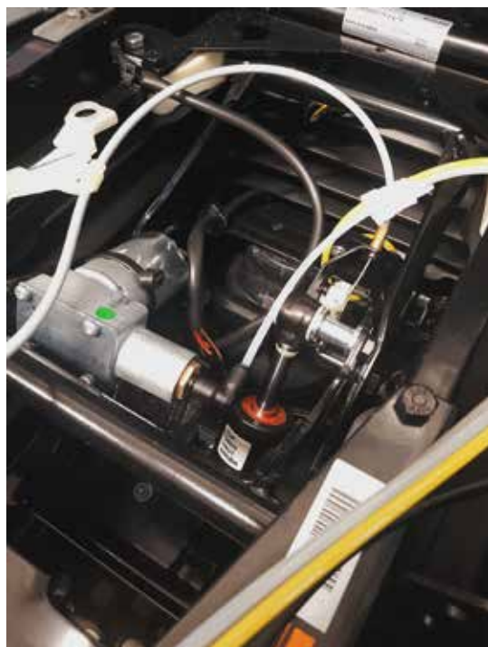
Zawieszenie pneumatyczne z kompresorem
