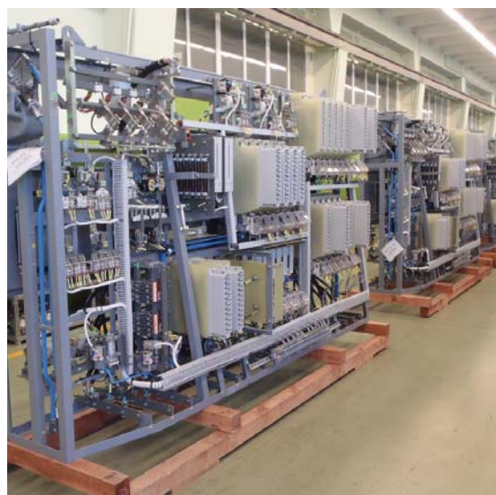
Szafy aparatuowe wysokiego napięcia typu XLE.
