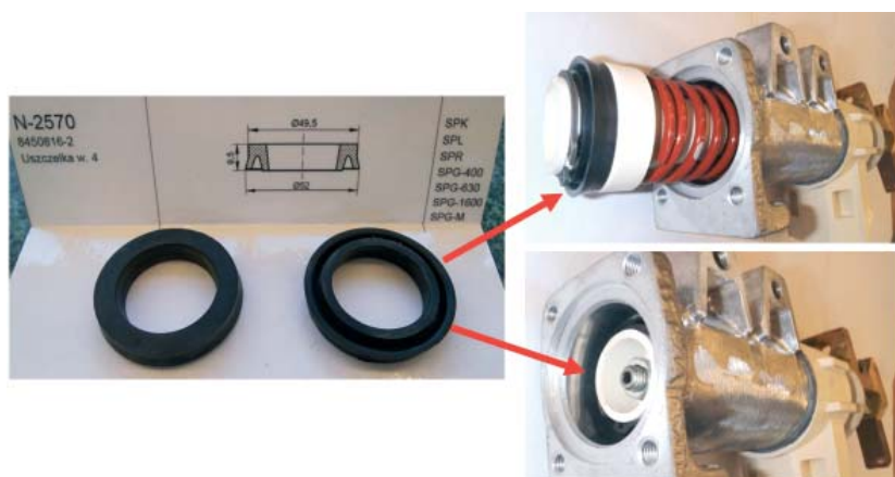
Fot. 2: Przykład zastosowania oryginalnych części przy wykonywaniu naprawy stycznika SPG.
