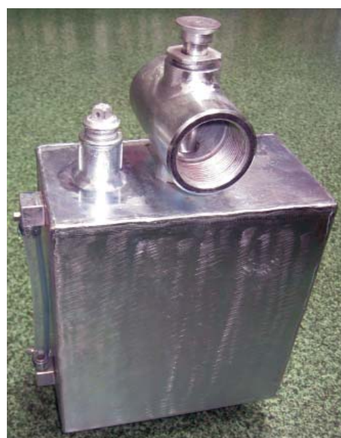
Fot. 4. Propozycja rozpylacza alkoholu o zwiększonej pojemności (4 l).
