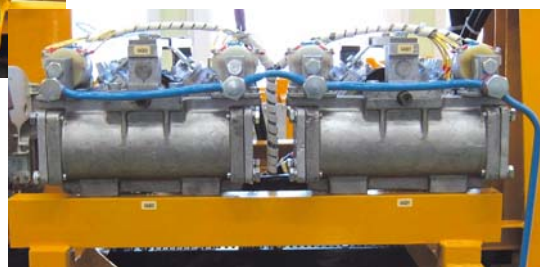
Zdalnie sterowany odłącznik silników trakcyjnych MAO-602/2 (lokomotywa ET22)
