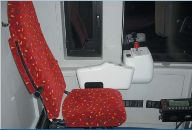
Nowy fotel pomocnika maszynisty na ED 74 i nowe elementy wyposażenia do obsługi.
