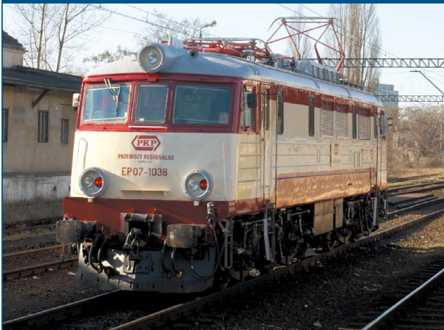
Kutno, 23.08.2007. Lokomotywa EP07-1038 spółki PKP Przewozy Regionalne po naprawie głównej. Dopuszczona do ruchu mimo braku wycieraczek oraz odwrotnie zabudowanego lewego reflektora. Fot. G.Moc
