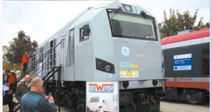
Lokomotywa 311D wykonana na podbudowie ST44.
